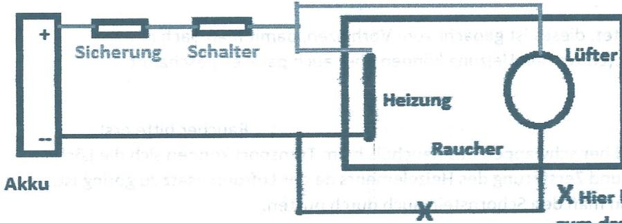
**X** Hier können Vorwiderstände zum drosseln des Lüfters eingebaut werden 1-6 Stück 4,7 Ohm 2W
