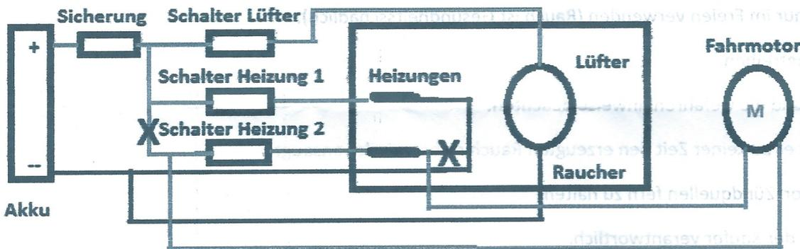
**X** Bei Ansteuerung der Heizung 2 über Fahrmotor entfällt Schalter 2
